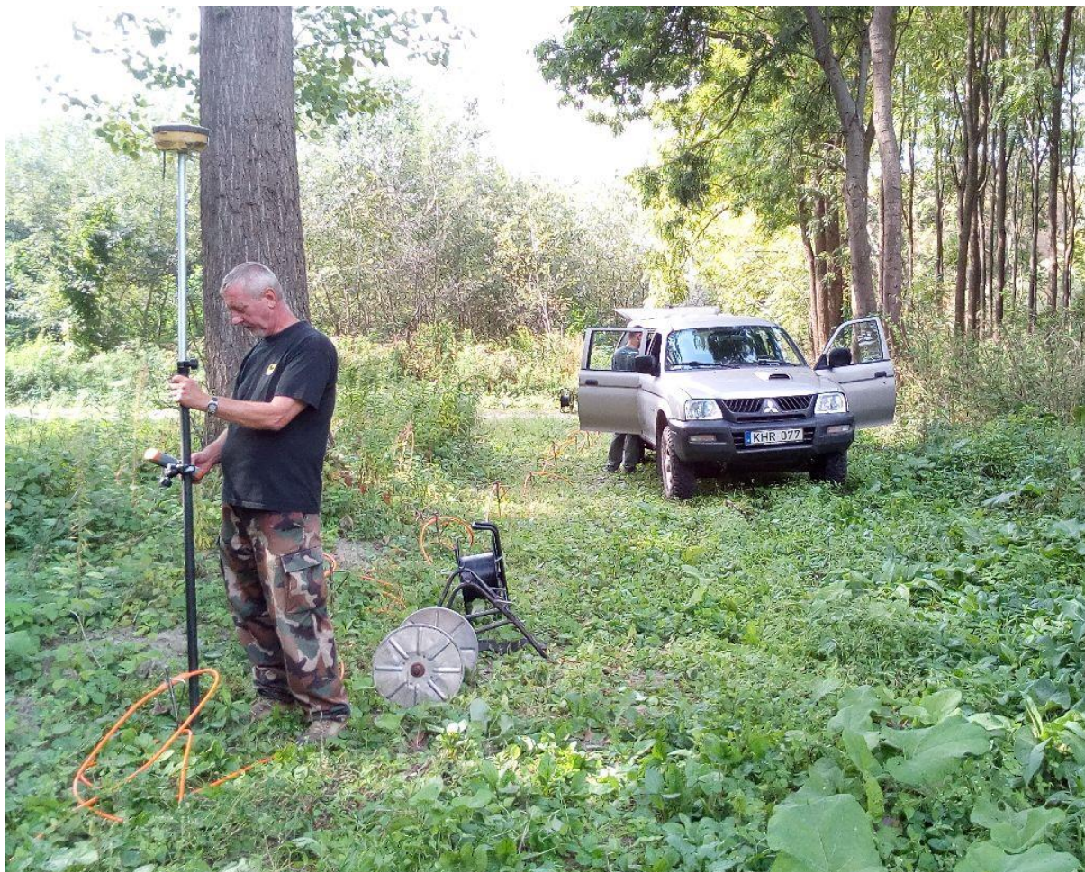
4. ábra: A szelvény pozíció meghatározása nagypontosságú RTK GPS-sel (Javad Triumph-1)
