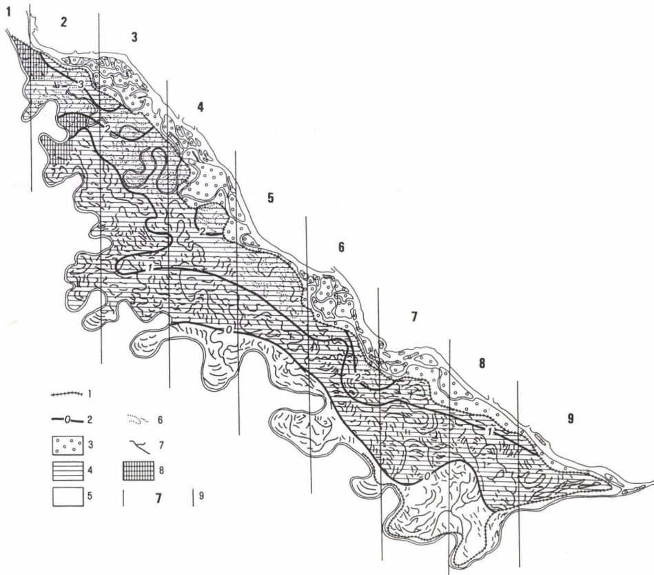
2. ábra. A Szigetköz geomorfológiai fáciesei és a várható talajvízszint-süllyedés által veszélyeztetett területek (Szerk.: BALOGH J.). – 1 = árvédelmi töltés; 2 = számított talajvízszint-süllyedés (m); 3 = veszélyeztetett ártéri erdők, zátonyszigetek, feltöltött meanderek; 4 = veszélyeztetett övzátonyok; 5 = a talajvízszint-süllyedés által nem érintett övzátonyok; 6 = a talajvízszint-süllyedésre érzékeny, hajdani feltöltött medrek; 7 = a talajvízszint-süllyedésre nem érzékeny, feltöltött medrek; 8 = jelenleg is rossz vízgazdálkodású övzátonyok; 9 = térképszelvények
