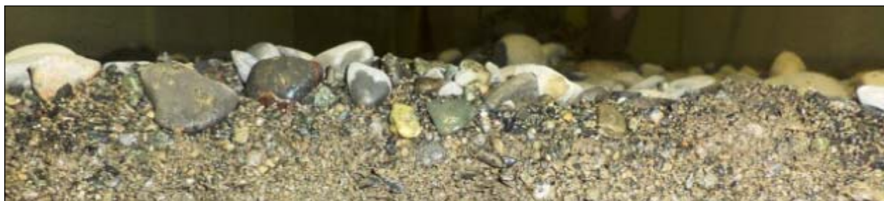
1. ábra. Bepáncélosodott meder metszete
