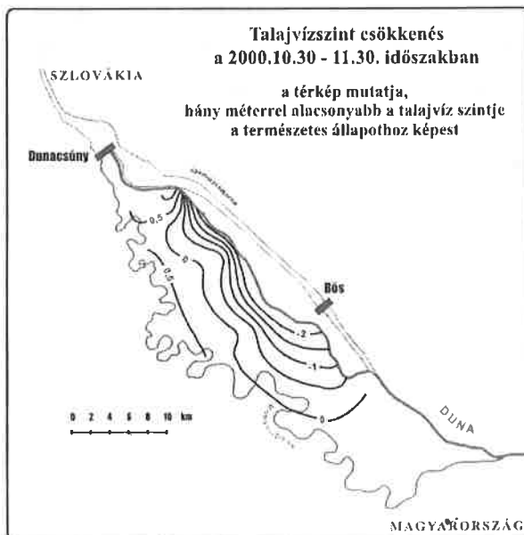
V.2-6. ábra A talajvízdomborzat változása “kisvizes” állapotban
