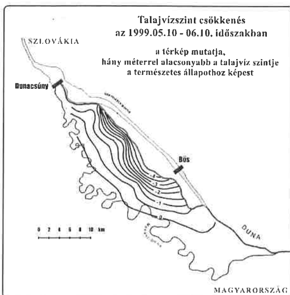
V.2-7. ábra A talajvízdomborzat változása “nagyvizes” állapotban
